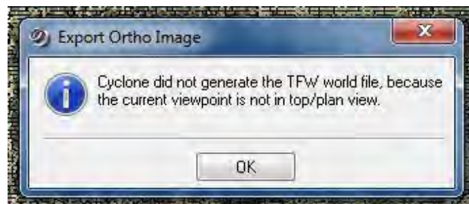
Fig 9 – La boîte de dialogue Export Ortho Image indiquant que Cyclone n'a pas réussi à exporter un fichier TFW car le point de vue courant n'est pas une vue de dessus ou un plan.
